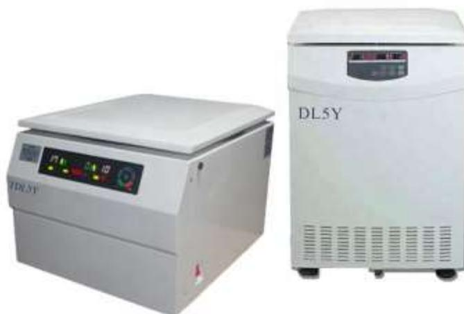
DL5Y / TDL5Y están diseñadas para la determinación de agua y depósitos en petróleo crudo. Cumple con los requisitos del estándar GB / T6533-86 y utiliza la separación centrífuga para determinar la cantidad de agua y depósitos en petróleo crudo. Es el equipo ideal para determinar la humedad en industria de exploración petrolera e instituto de investigación.
