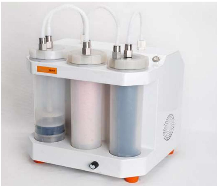
El sistema de neutralización tiene un efecto perfecto de neutralización y rendimiento de absorción, puede neutralizar la neblina ácida y el gas residual de reacción de Kjeldahl u otros experimentos. Adopte la bomba anticorrosión de eficiencia para un diseño de dispositivo de absorción único y eficiente. Hace que el área de contacto se expanda con gas / líquido, neutraliza perfectamente el gas ácido, hace que el entorno operativo sea amigable
